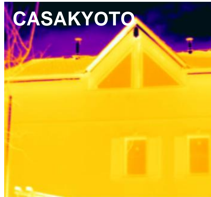
Termografia di edificio isolato adeguatamente - Casakyo
